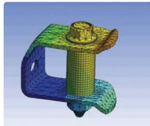
拧紧力引起的螺栓的应力（螺栓预紧功能）
