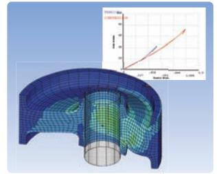
使用粘弹性 - 超弹性材料的橡胶衬套的应力分布
