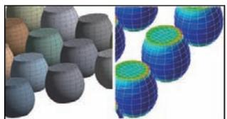
这是通过 ANSYS 分布式求解对焊锡蠕变进行仿真的案例。ANSYS Release17 利用高达 1000 核的计算功能实现高度可扩展性。
