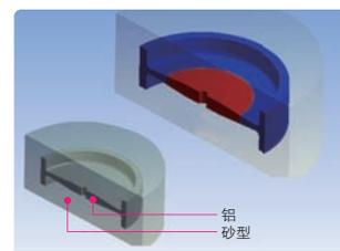
飞轮的铸造（液体到固体的过渡阶段）
