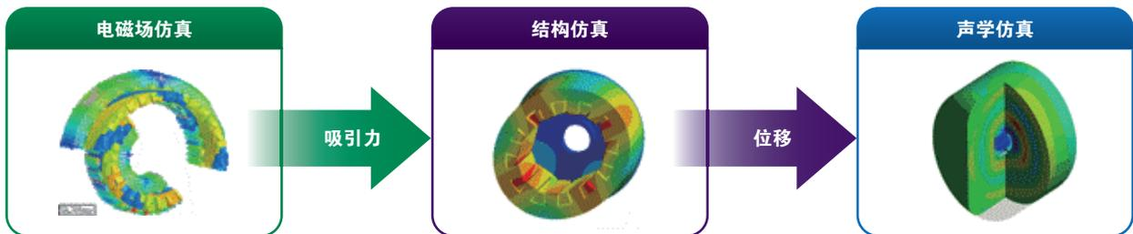
电机的电磁场 - 结构 - 声学耦合仿真
