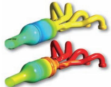
汽车排气歧管中的表面热双向 FSI 仿真
