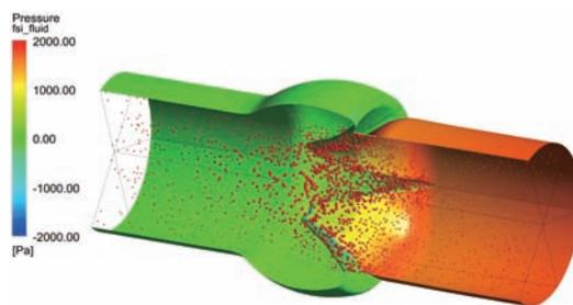
对具有三个瓣叶的心脏瓣膜上流动的血流 (非稳态流) 进行双向 FSI 仿真
