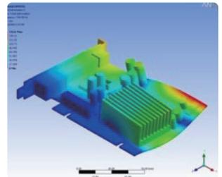
电路板的随机振动
