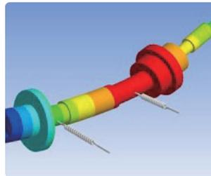
微型燃气轮机中的转子动力学
