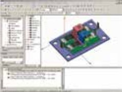
从 ANSYS Q3D、ANSYS HFSS 抽取模型的 变频器传导干扰仿真
