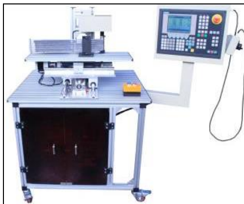
图 5 无模弯曲实验装置
