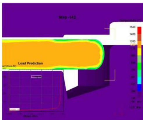
图 4 齿轮预制坯锻造成形
