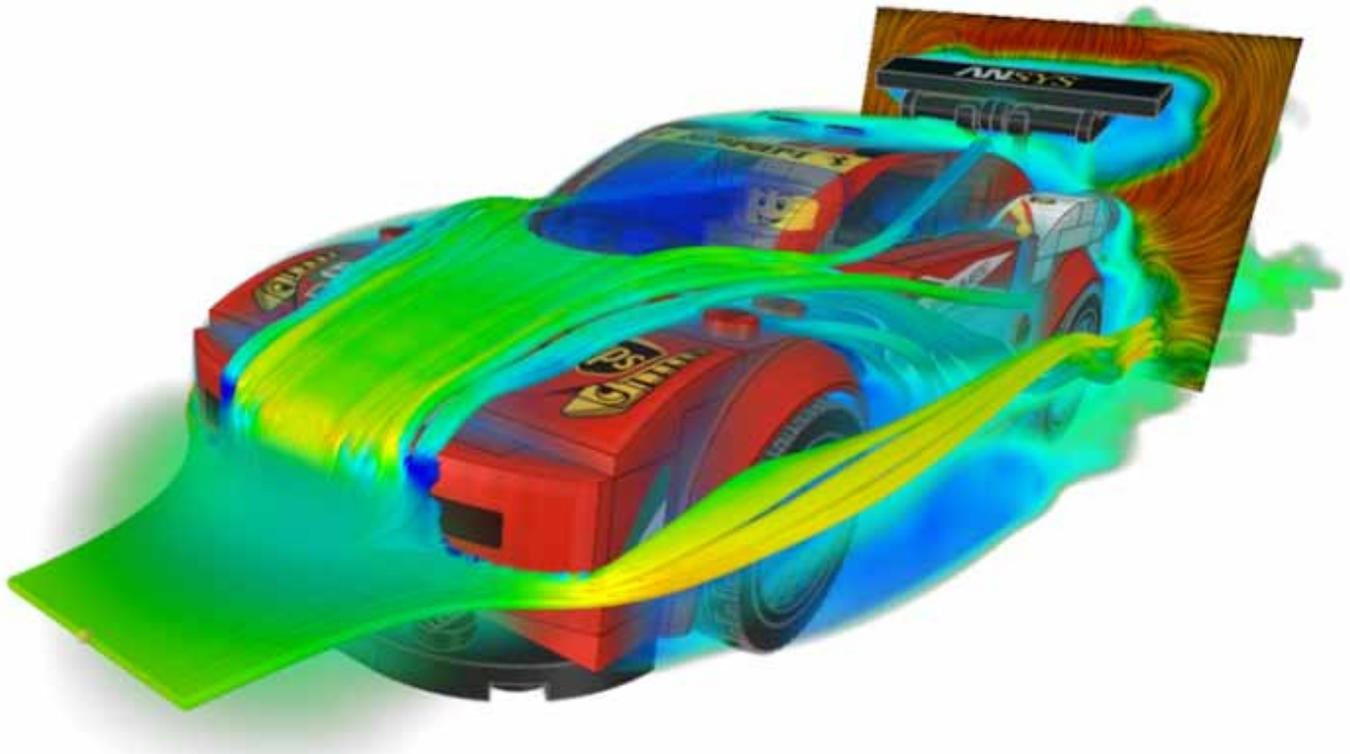
使用 ANSYS Discovery Live，工程师可以实现即时仿真，该功能与直接建模紧密结合，使工程师能够实现交互式的设计探索和快速的产品研发。这种前所未有的交互式体验，使工程师在修改几何模型、材料类型或载荷输入的同时，立即看到计算结果的变化。
